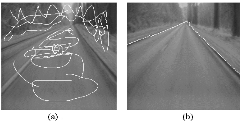
Figure 17: Marqueurs de la chaussée et de l'extérieur définis manuellement (a), LPE du gradient contrôlée par ces marqueurs (b)
