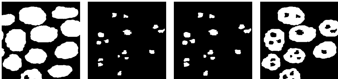
De gauche à droite: bouchage des trous, trous isolés, trous dilatés, résultat de la reconstruction géodésique (particules avec trous).
