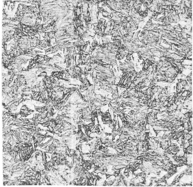
Martensite \theta_{\gamma} = 900^{\circ} \text{C} - trempe eau
