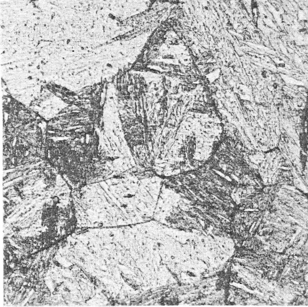
Martensite \theta_{\gamma} = 1100^{\circ} \text{C} - trempe eau
